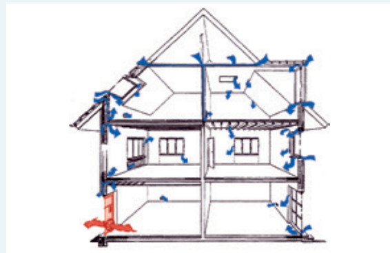
Il principio del BlowerDoor Test: un ventilatore aspira aria dall'involucro edilizio. L'aria esterna „scorre“ all'interno dell'involucro attraverso tutti i punti non impermeabili all'aria.
